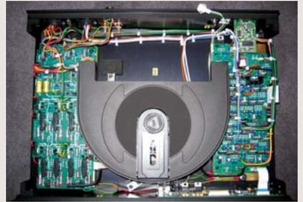
Una vista d'insieme dell'interno del telaio principale del CD555. Si notano la costruzione divisa in schede separate e il grosso crototelaio che supporta la meccanica. La filatura potrebbe sembrare, a prima vista, abbondante, ma ad un'attenta analisi è estremamente logica.
