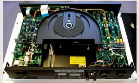
Qui si intuisce la stratificazione dell'elettronica del lettore: diverse schede sovrapposte dedicate a differenti compiti, con gli stabilizzatori mantenuti in prossimità dei componenti a cui forniscono l'alimentazione. Il colore del crototelaio della meccanica è dato da una speciale vernice che assorbe la luce irradiata dal laser di lettura.
