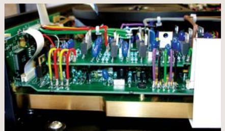
La piastra in ottone che supporta la scheda è spessa e pesante. Ce n'è un'altra, completamente separata, dall'altro lato del lettore. A sinistra si può notare una delle molle elicoidali che sospendono la piastra: anche l'elettronica è sospesa, nello sforzo di annullare qualsiasi effetto negativo delle vibrazioni. Una tradizione dei lettori top di Naim.
